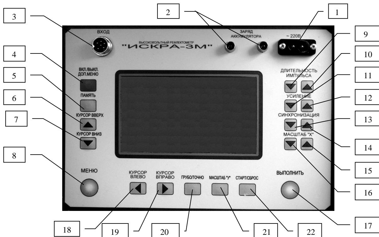
1. Разъём для подключения питания встроенного зарядного устройства.
