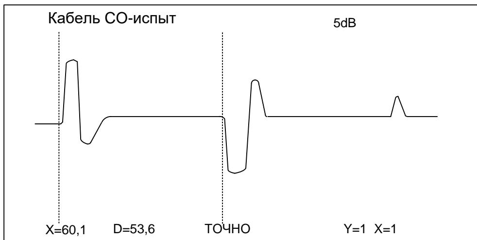
Рис.3.1. Пробой на расстоянии 53,6 м (сигналы с ДИН связь по напряжению).
