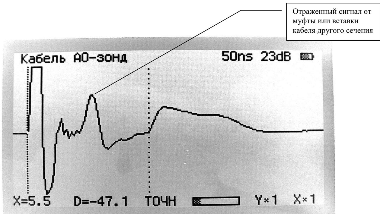
Рис.1.2 Обрыв на расстоянии 47.1м при разных масштабах.
