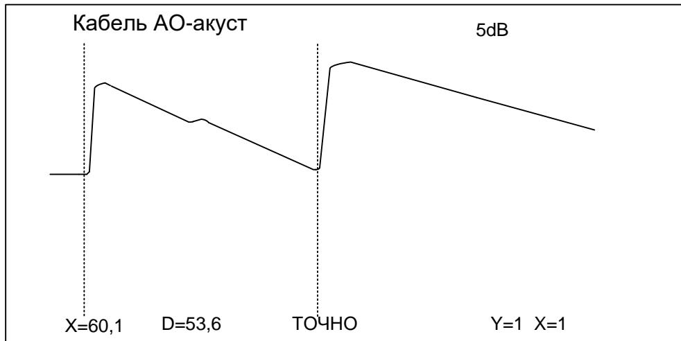
Рис.2.1 Пробой на расстоянии 53,6 м .
